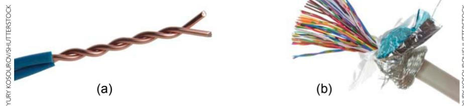
Outro sistema que usa canal fio é a TV a cabo por assinatura. No entanto, diferentemente da rede de telefonia, que emprega o par trançado de fios, o sinal de TV chega à casa do assinante por um cabo coaxial, com aspecto físico e caracte-
